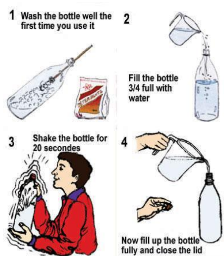
SODIS exposing procedure, step 1
